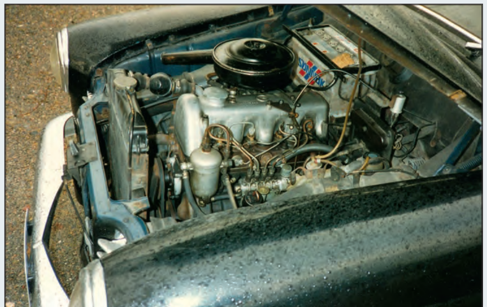
Motorrommet i 180Dc. Ganske lett tilgjengeleg, til og med når verktøyet berre er ein skiftenøkkel.
